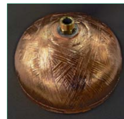
Mit Kupferfolie metallisierter Tank aus Faserverbundkunststoff zur Speicherung von flüssigem Wasserstoff
